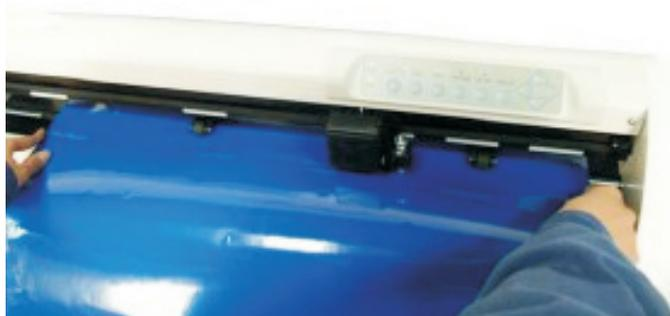
3. Mova então os pressionadores manualmente para a posição apropriada, ou seja, abaixo das marcações brancas na base da plotter de recorte. As marcações brancas indicam onde exatamente estão as áreas recartilhadas da plotter de recorte.
