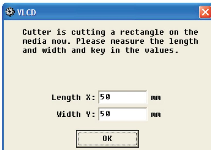
Ao clicar em OK, a plotter faz o corte.e sobe outra tela. Depile o material cortado e faça a medid, coloque nos campos da tela a medida exata do corte efetuado, em seguida clie em OK.
