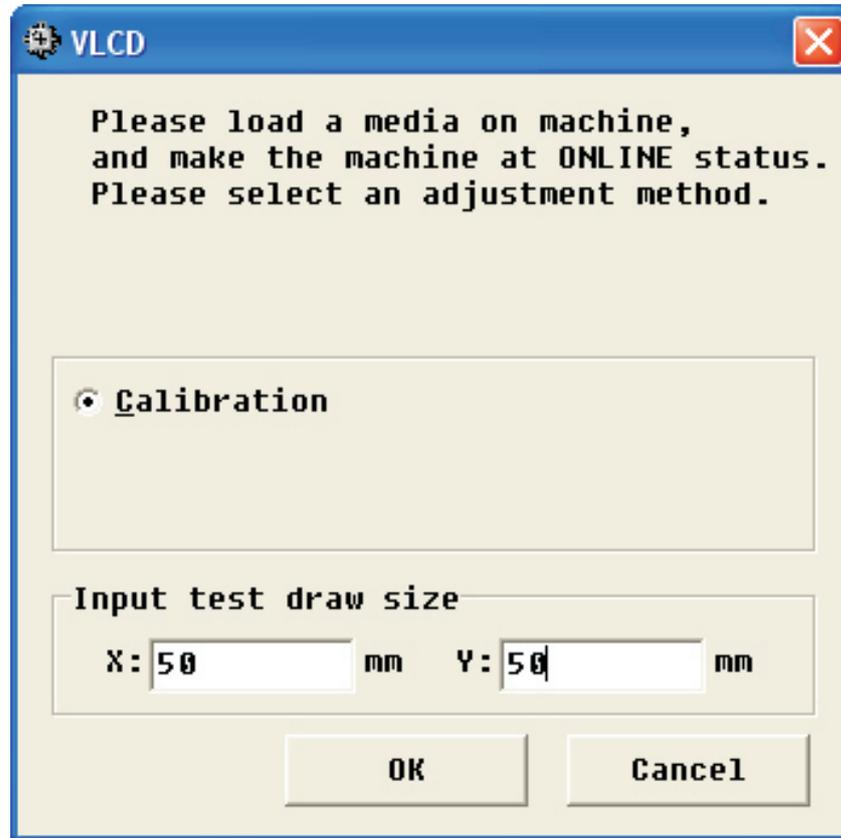
Nessa tela coloque um valor para ser cortado, a plotter vai cortar um quadrado ou retângulo conforme a medida que você coloque nos campos para a correção do corte. Clique em OK.
